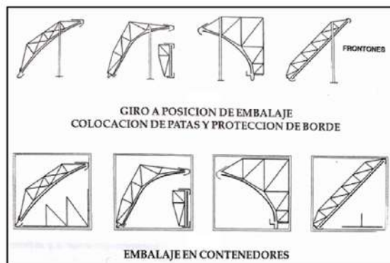
FIGURA 10 - POSICIÓN DE LAS DIFERENTES PARTES EN EL INTERIOR DE LOS CONTENEDORES
