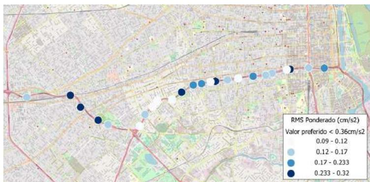
FIGURA 2. LÍNEA DE BASE DE VIBRACIONES - RMS PONDERADO - CONFORT
