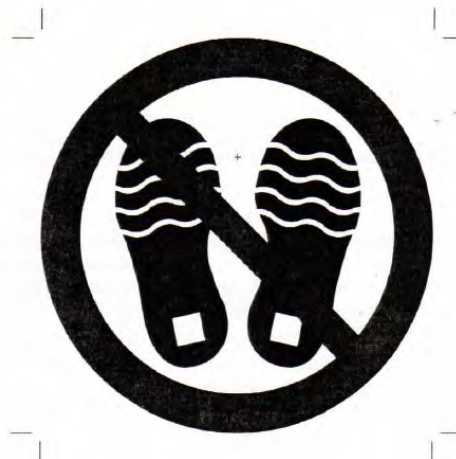
Figura 9 – Ejemplo de aviso contra pisadas en el techo
