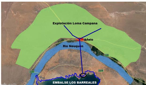
Imagen 14. Propuesta de esquema de abastecimiento de agua en la localidad de Añelo y explotación en Loma Campana. En línea azul, el acueducto con toma en el embalse Los Barreales.
