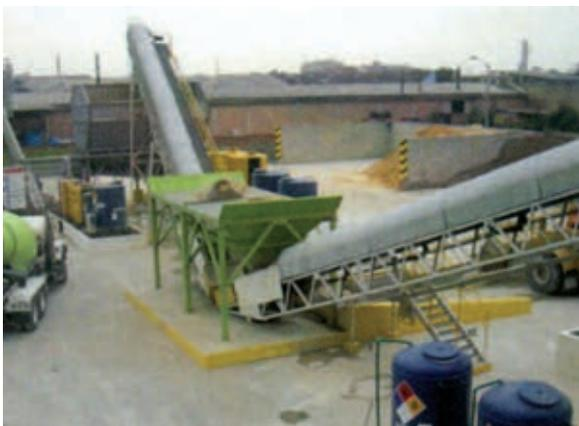
*Cinta transportadora con cobertura metálica*
