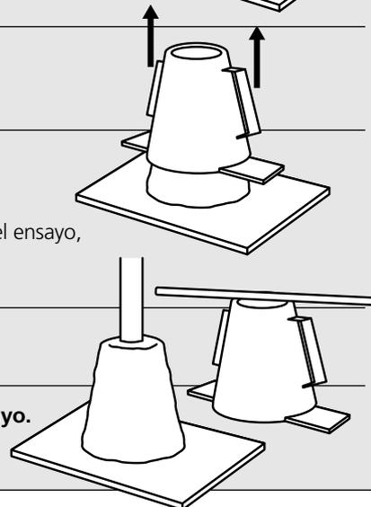
g. **Cohesión de la mezcla:** Consiste en una verificación ocular que constate cierta facilidad para la segregación de los materiales al quedar en libertad el cono de hormigón, en especial en la forma como se separan los agregados gruesos y el agua, que son los
